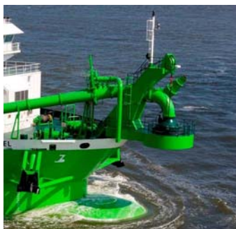
Figura 27: TSHD instalação de acoplamento
