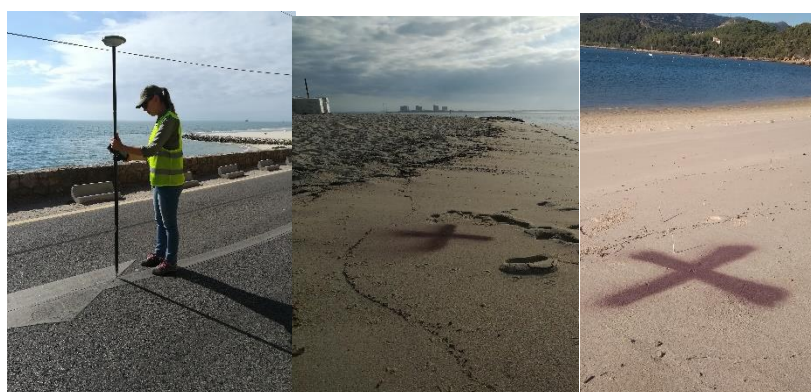
Figura 20: Exemplos de Pontos de Controlo utilizados
