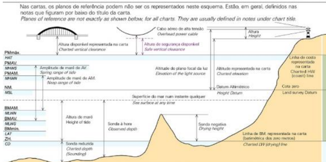
Figura 2: Esquema dos diferentes referenciais altimétricos (Fonte: IH)
