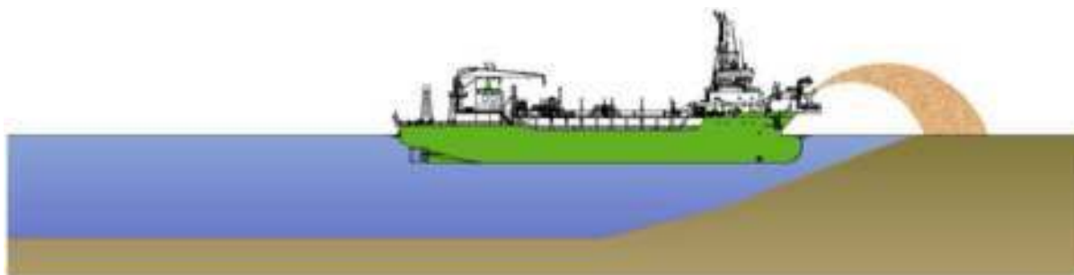
Draga de Sucção em Marcha (TSHD) em operação de descarga pelo método “rainbow”
