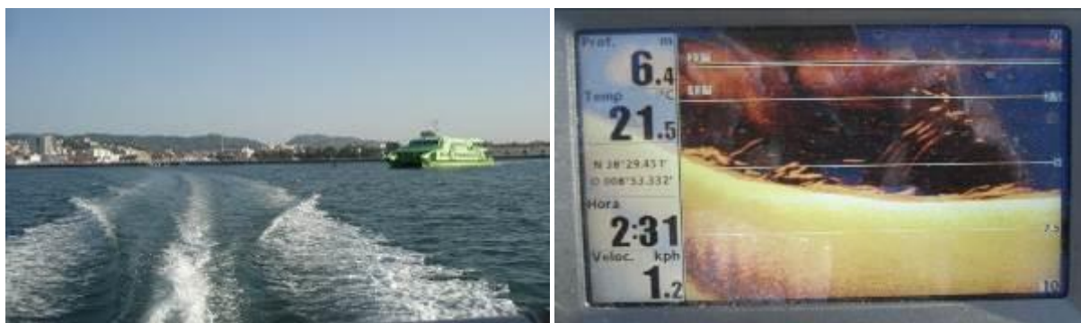
Fig. 30 e 31 - Leitura em tempo real do Sonar de Varrimento Lateral
