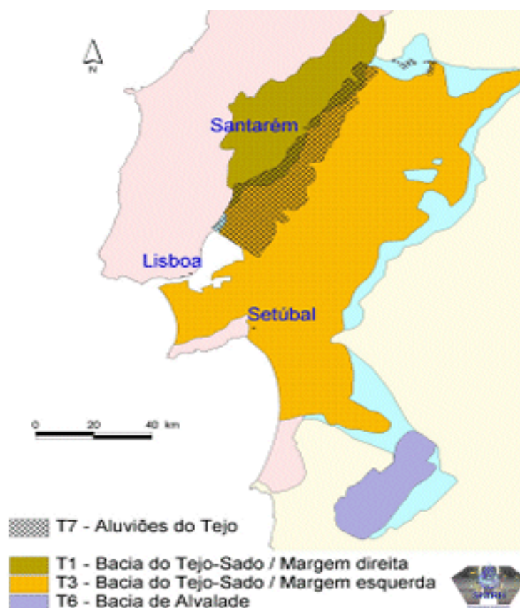
Figura 5.36 - Distribuição dos sistemas aquíferos na unidade hidrogeológica Bacia do Tejo-Sado (Fonte: SNIRH, Sistemas Aquíferos)
