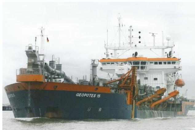
**Figura 3.3 – Draga-tipo recomendada para efetuar as operações de dragagem/deposição**
