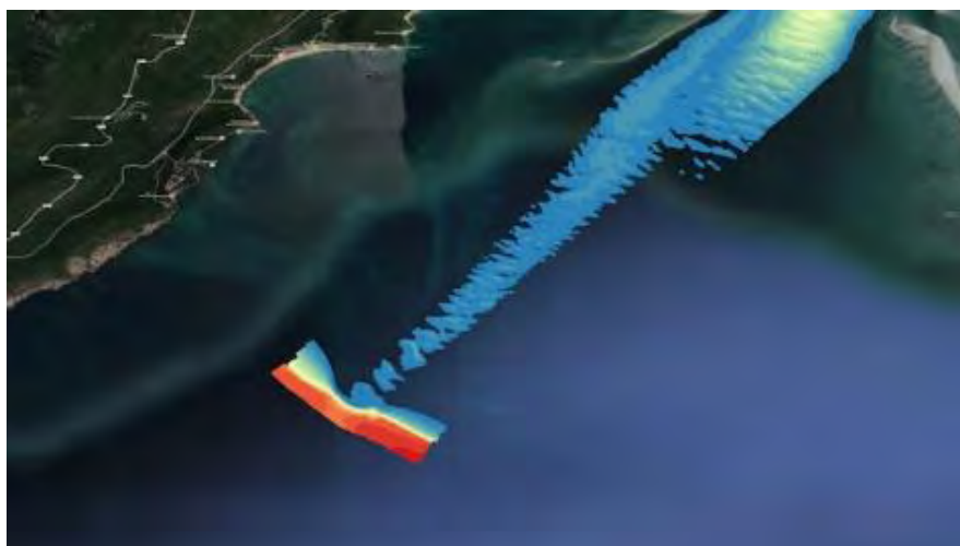
Figura 66: Levantamento multifeixe do canal de navegação realizado em 2016
