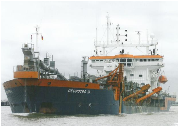
Figura 5 - Draga-tipo preconizada para efetuar as operações de dragagem Fonte: Van Oord
